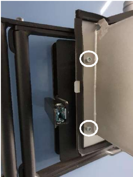
Vis de fixation brûleur sur porte latérale.
