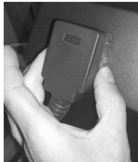
Enficher le connecteur rond au brûleur. Visser la bague de verrouillage.
