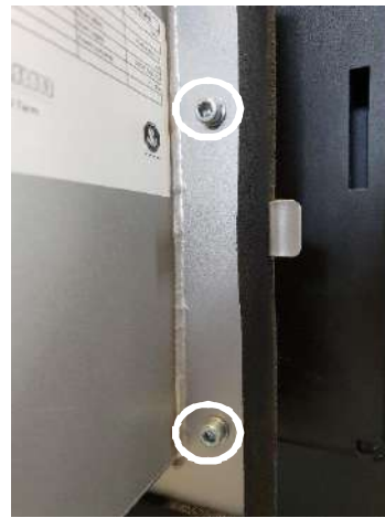
Vis de fixation brûleur sur porte avant.
