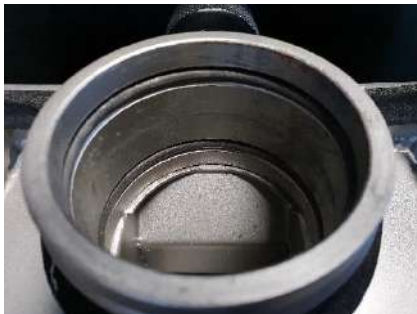
Attention aux joints toriques dans le cylindre.
