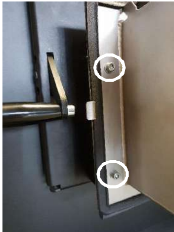
Vis de fixation brûleur sur porte avant.
