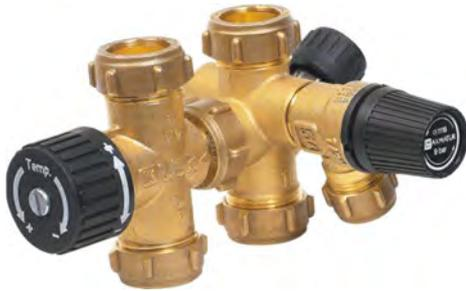
Permet en plus du groupe de sécurité de mitiger l'eau chaude sanitaire de 38°C à 65°C (important lors d'un ballon en bain-marie qui atteint 85°C). La réglementation en vigueur impose ce type d'appareil.
