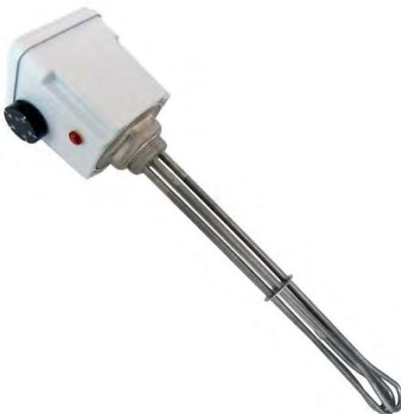
Cette résistance chauffante peut être raccordée aussi bien en 230/240V monophasé qu'en triphasé 380/400V, et dispose d'un thermostat de sécurité de surchauffe et d'un thermostat de réglage avec position hors-gel.
