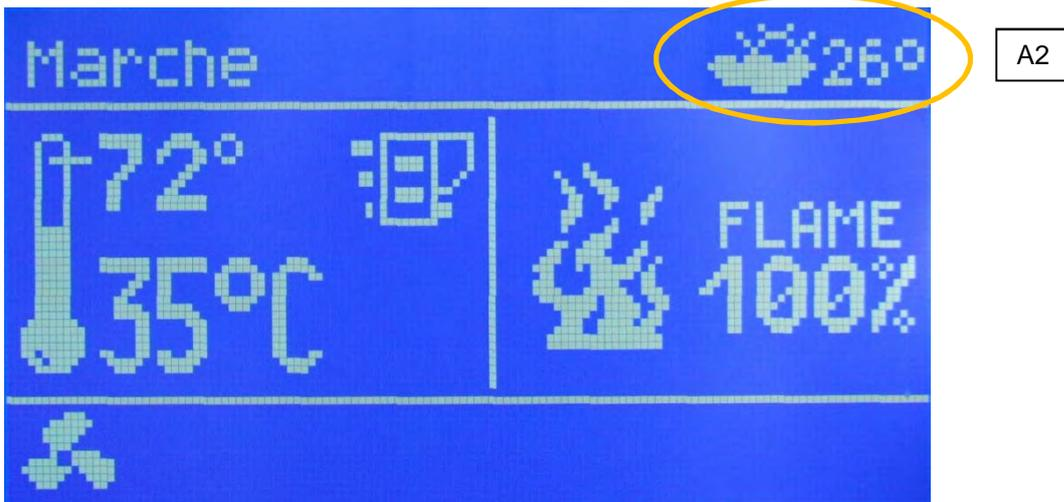
**A2 : Température extérieure (si la sonde extérieure est raccordée)**
