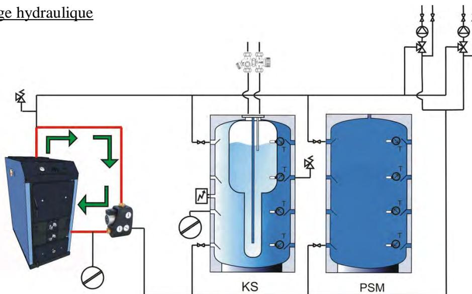
Phase de chauffe avec réchauffage des retours
