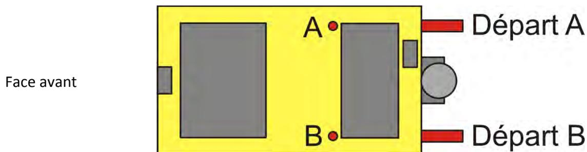
En livraison standard, les sondes sont placées dans l'un des doigts de gant. Il appartient à l'installateur professionnel de placer les sondes dans le doigt de gant correspondant au départ hydraulique choisi.
