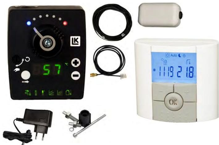
Régulation climatique avec sonde extérieure, sonde d'ambiance, sonde de départ, par connecteurs RTC, pour radiateur ou plancher chauffant. Programmation hebdomadaire, réglage de courbe de chauffe, décalage parallèle de courbe, température de départ minimale et maximale. Indication d'ouverture ou fermeture de vanne par voyants. Alimentation par transformateur.
