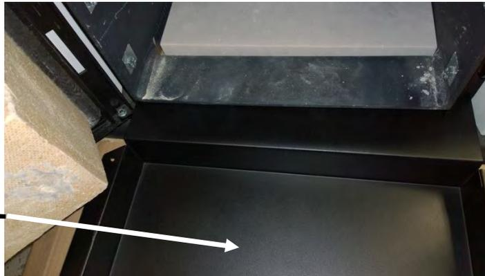
a) Décendrage du magasin contrôle des sorties d'air primaire.
