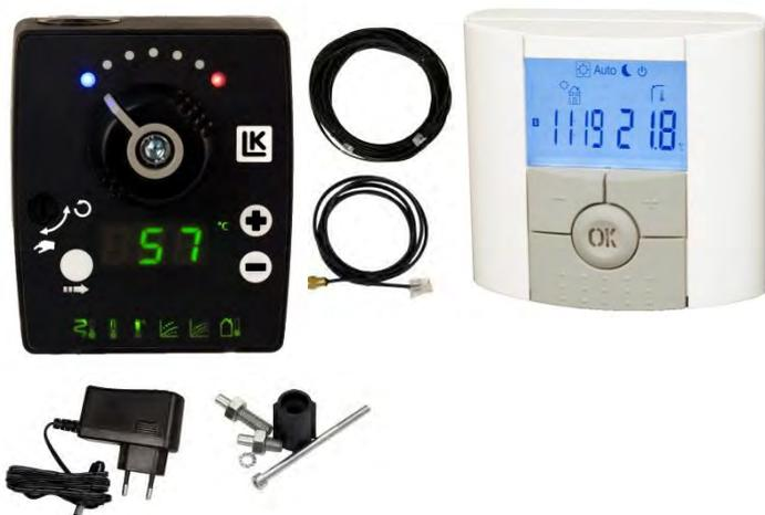
Régulation d'ambiance sans sonde extérieure, avec sonde de départ, par connecteurs RTC, pour radiateur ou plancher chauffant. Programmation hebdomadaire, réglage de courbe de chauffe, décalage parallèle de courbe, température de départ minimale et maximale. Indication d'ouverture ou fermeture de vanne par voyants. Alimentation par transformateur.
