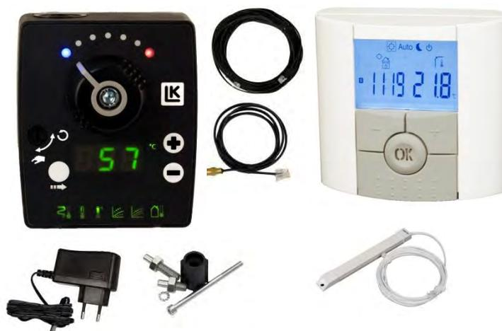
Régulation d'ambiance sans sonde extérieure, avec sonde d'ambiance sans fil (commande par radiofréquence), sonde de départ, par connecteurs RTC, pour radiateur ou plancher chauffant. Programmation hebdomadaire, réglage de courbe de chauffe, décalage parallèle de courbe, température de départ minimale et maximale. Indication d'ouverture ou fermeture de vanne par voyants. Alimentation par transformateur.
