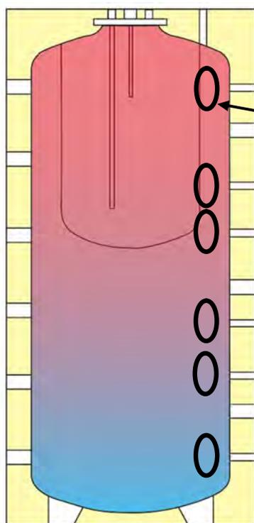
Les pattes sont disposées à la même hauteur que les orifices thermomètres.
