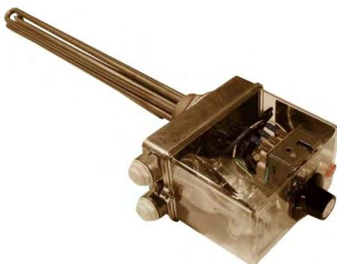
Cette résistance chauffante peut être raccordée aussi bien en 230/240V monophasé qu'en triphasé 380/400V, et dispose d'un thermostat de sécurité de surchauffe et d'un thermostat de réglage avec position hors-gel.
