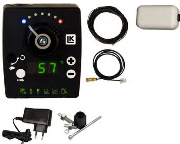
Régulation climatique avec sonde extérieure et sonde de départ par connecteurs RTC, pour radiateur ou plancher chauffant. Réglage de courbe de chauffe, décalage parallèle de courbe, température de départ minimale et maximale. Indication d'ouverture ou fermeture de vanne par voyants. Alimentation par transformateur.
