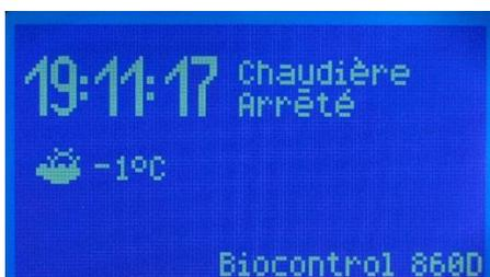
Ni la chaudière, ni aucune fonction (chauffage, ecs, ...) n'est active
