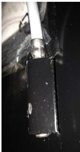
Fixation d'une sonde, plaquette frappée au marteau
