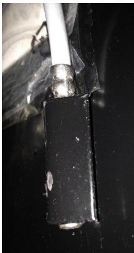
Fixation d'une sonde, plaquette frappée au marteau
